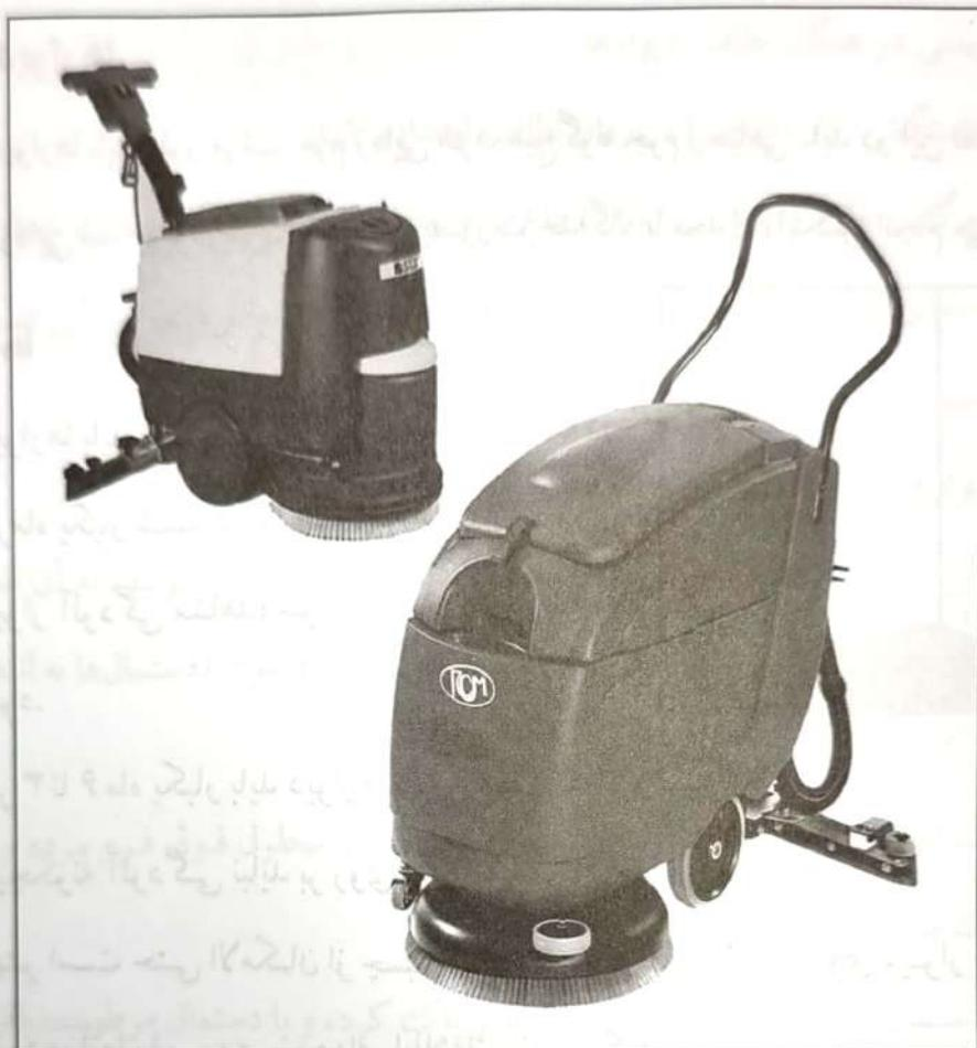
در انتهای دستگاه یک تی قرار گرفته که توسط یک خرطومی به مخزن آب کشیف و موتور مکش متصل است. با ادامه حرکت دستگاه آب کشیف ایجاد شده در مرحله شستشوی سطح توسط تی عقب به صورت کامل جمع آوری شده و به کمک موتور مکش دستگاه به داخل مخزن آب کشیف ریخته می‌شود.
